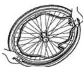
Presione el neumático sobre la llanta, empezando por detrás de la válvula. Hínche la cámara ligeramente hasta que empiece a redondearse y colóquela dentro del neumático.
