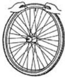
Cuando la cámara se encuentre dentro de la rueda sin arrugarse (si presenta arrugas, deje salir un poco de aire), se puede montar la parte superior de la rueda con facilidad presionando con ambas manos empezando de nuevo por la válvula.
