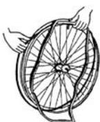
Coloque el fondo de la llanta en posición por encima de la válvula de aire antes de insertarlo en la llanta. A continuación, el fondo de la llanta se puede colocar por encima fácilmente. Compruebe que todos los extremos de los radios están cubiertos (el fondo de la llanta no es necesario en el caso que la llanta sea de plástico).
