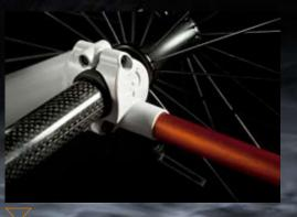
Graças às suas partes soldadas, a fixação do eixo traseiro apresenta uma grande rigidez, com um peso muito reduzido. O tubo do eixo está disponível em alumínio ou carbono.
